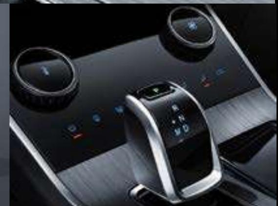
Palanca de cambios tipo **Joystick**
